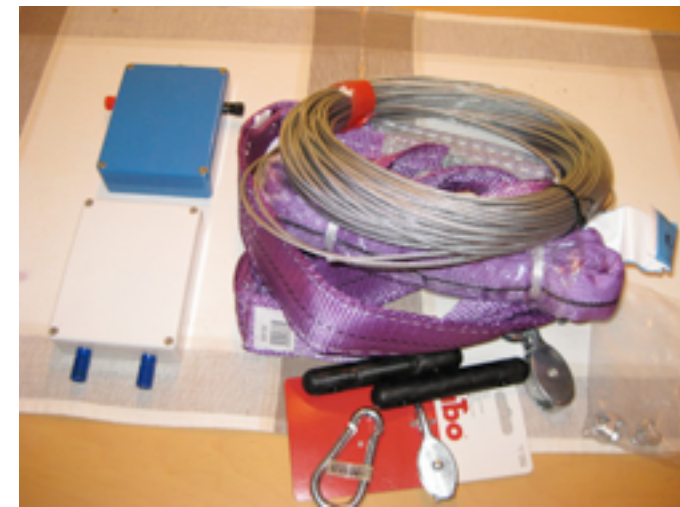
Antennin osat, kuvasta puuttuvat antennin kiristyksessä tarvittavat painot.
