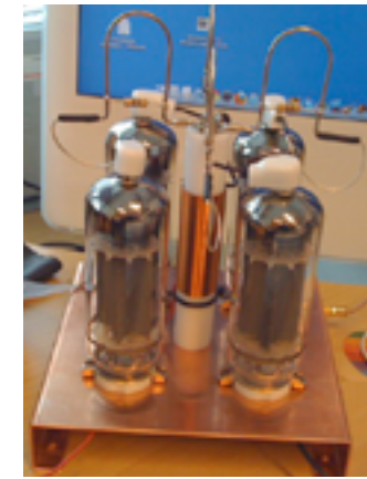
Putket koekasattuna omaan asennuslevyynsä
