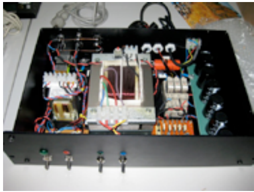
Poweri valmiiksi koottuna ja testattuna. Lepovirta on luokkaa 200mA, tyhjäkäyntijännite noin 1360V
