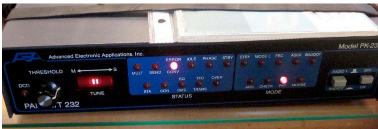
Sanoma-TNCnä PK232 yhdistettynä F T817 ja läppäriin AGWPE ja AGWTerminal-softilla (kuva OH7HJ)
